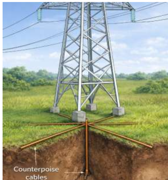
Gambar 2.4 Sistem counter poise pada tower
