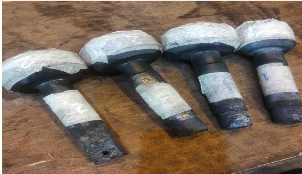
Gambar 1. 2 Lock nut disc GV yang rusak dan dipotong
