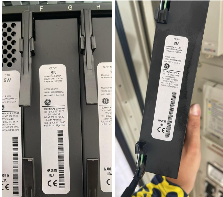
Gambar 4.6 Modul CT yang lama dan yang baru
