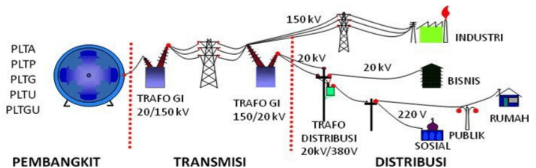
Gambar 2. 1. Diagram Alur Sistem Tenaga Listrik Dari Pembangkitan Hingga Distribusi Ke Konsumen
