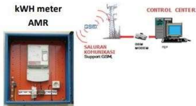
Gambar 2. 22 Konfigurasi Sistem AMR Komunikasi Langsung
