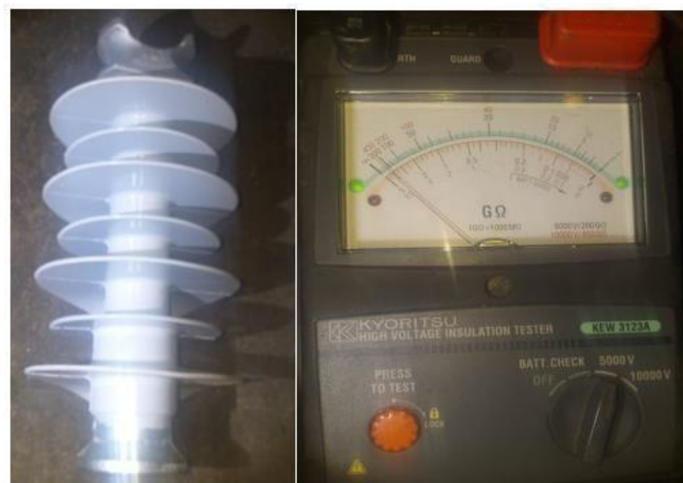
Gambar 4.5 Kondisi Isolator Post Baru dan Hasil Pengukuran Tahanan Isolasi Setelah Penggantian
