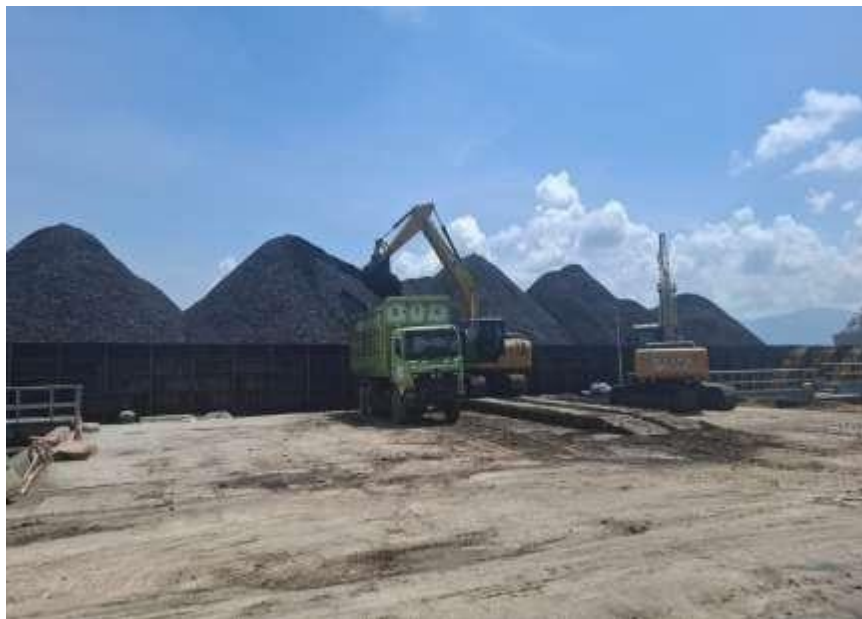
Gambar 2. 6 Pembongkaran Batu Bara Dari Jetty
