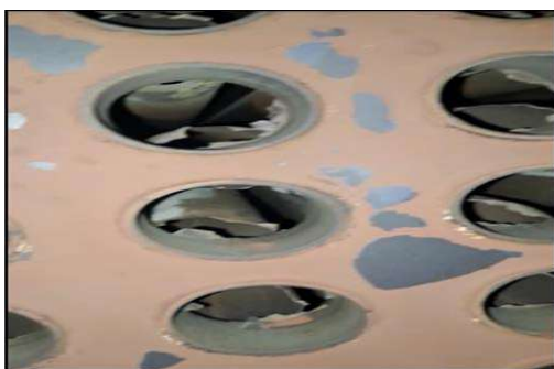
Gambar 2. 19 Korosi pada Tube Air Heater
