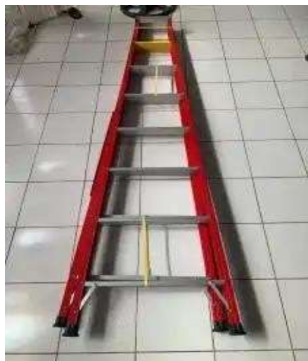
Gambar 2. 27 Tangga fiber 20kV
