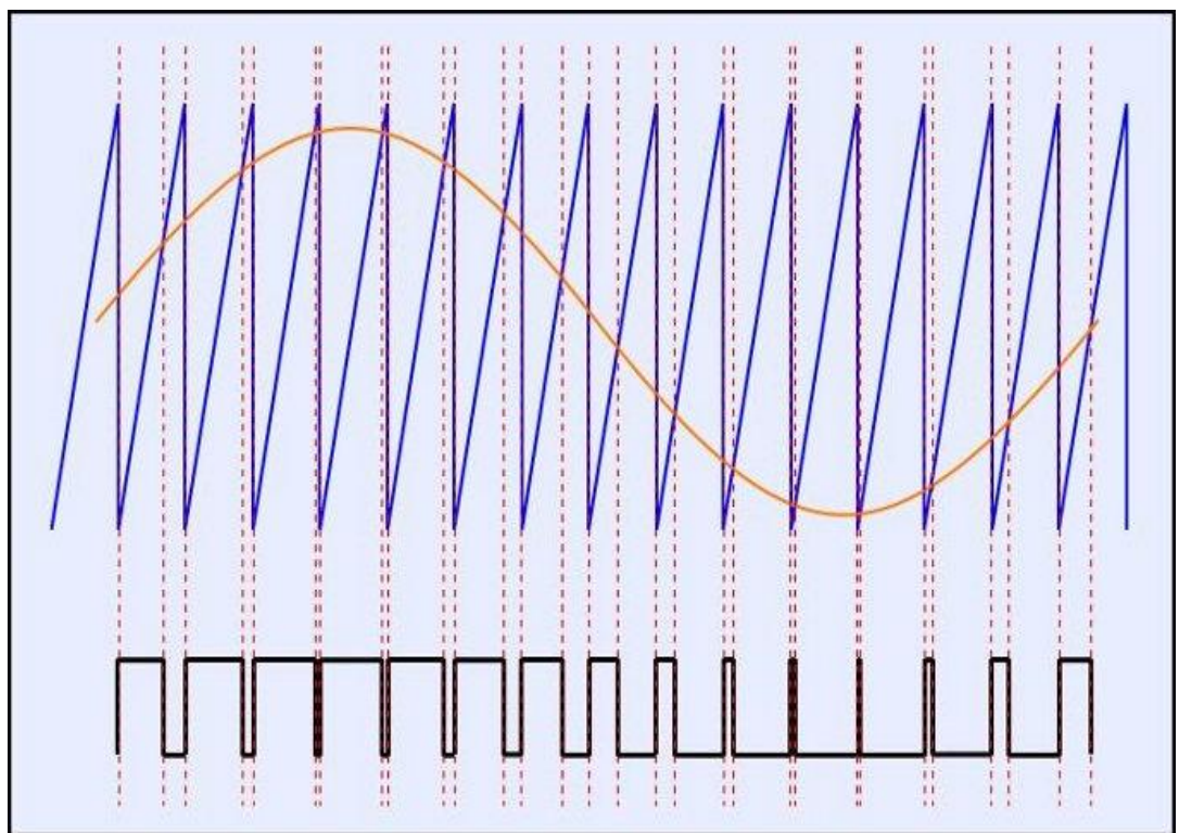
Gambar 2.3 Komparator sinyal analog dan persegi yang menghasilkan sinyal PWM
