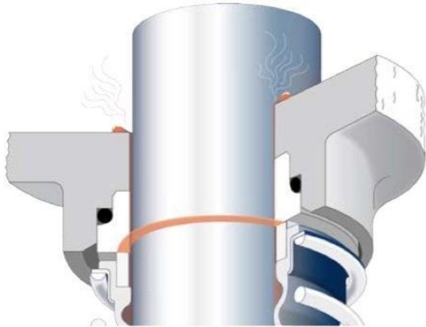
Gambar 2.13. Pelumasan Mechanical Seal oleh Fluida dari Pompa
