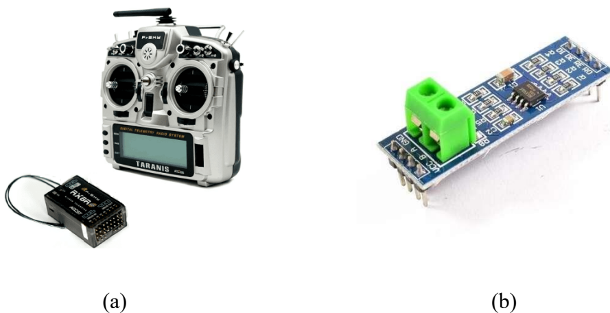
Gambar 2. 4 (a) Remote Frekuensi, (b) Komunikasi Serial RS485
